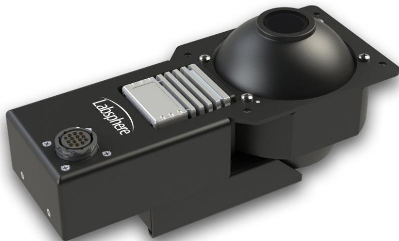
多くのモバイルデバイスには昼白色LEDをバックライトとするLCDディスプレイが備わっています。これらは蛍光体を励起して、昼白色を作り出しています。これらのディスプレイを校正するために使用される分光計、色差計は通常ハロゲン光源で校正されています。しかし測定器の校正誤差、迷光によって、ディスプレイの測定に一貫性のない結果をもたらします。このエラーを修正する最良の方法は、ディスプレイのバックライトのスペクトルに一致する光源で校正することです。Spectra-SSLは非常に安定した正確な積分球均一光源で、ディスプレイの正確な測定のための、機器校正に最適です。
